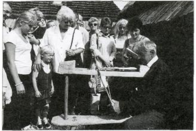
Antoni Frączek z Bukowej na ręcznej tokarni wykonywał wrzeciona tkackie
