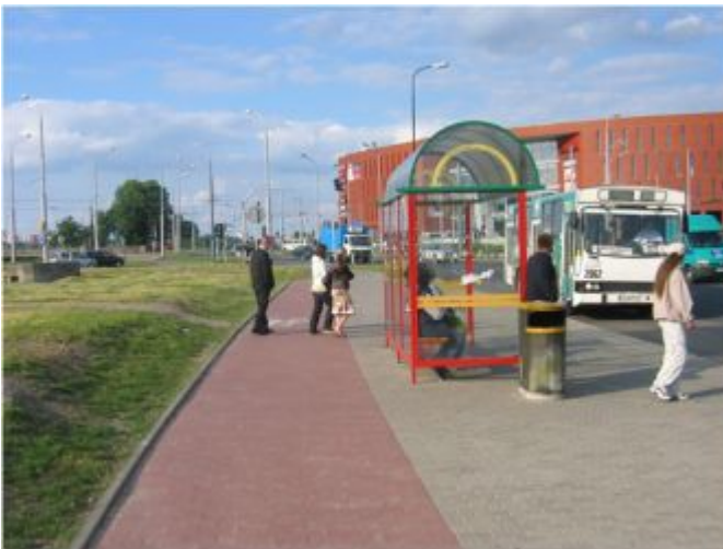
Brak rozgraniczenia powoduje, że oczekujący stoją na drodze dla rowerów. Problem 7: Ogrodzenie
